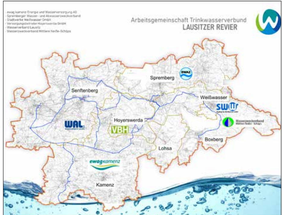
Die Karte zeigt das Gebiet des 2021 gegründeten Trinkwasserverbunds. Blau eingezeichnet ist das 1.400 Kilometer lange Trinkwasser-Leitungsnetz, das von Tettau aus große Teile der Lausitz abdeckt.
