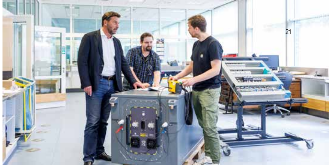
Die Wechselstation für elektrisierten Lastverkehr liegt bereits als detaillierte Planung samt aller Daten für Konstruktion und Energiemanagement vor; ein Prototyp der 1,5 Tonnen schweren Batterie (siehe Bild) lagert sicher im IBAR-Tempel.
