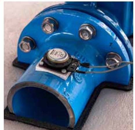
Teilausschnitt Prüfstand Leckortung Foto: Schönborner Armaturen GmbH
