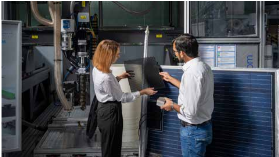
Die Wabenkonstruktion ermöglicht Leichtigkeit bei zugleich hoher Festigkeit. Foto: BTU
