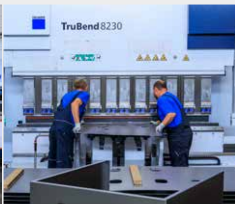
Bildtitel: Markus Garlich, Leiter Technik, erläutert den Gästen den Produktionsablauf eines Gehäuses: Stanz-Lasern, Biegen, Schweißen (v.l.n.r.)
