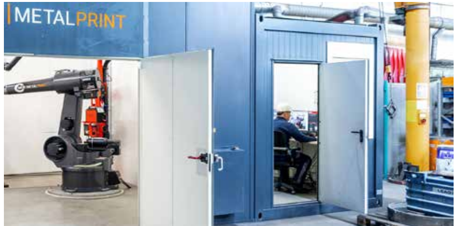
Auch das Energieunternehmen LEAG stellt sich neu auf: Das Tochterunternehmen MCR Engineering Lausitz GmbH nahm im Frühjahr eine neue 3D-Laser-Schweißanlage in Betrieb. Der computer-gesteuerte Metalldrucker kann große Maschinenbauteile schonend reparieren. Foto: LEAG
