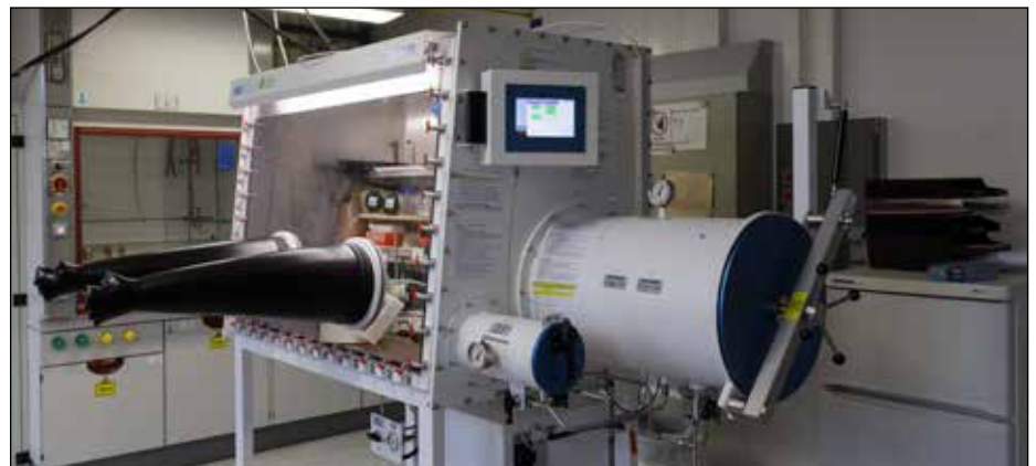
Glovebox zur Herstellung der Perowskitesubstrate, auf denen die Atomlagenabscheidung durchgeführt wird, Foto: Karsten Henkel, BTU
