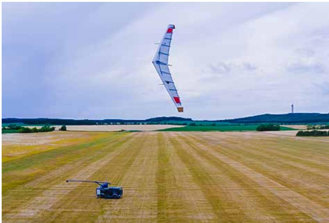
Betrieb der EnerKite bestehenden 30kW-Testanlage inkl. Bodenstation, bestehend aus Mast, Drehplatte und Container.
