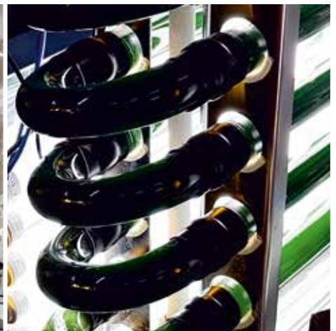
In diesem Senftenberger Labor werden Bioreaktoren mit Online-Sensorik zur Untersuchung von Spirulina-Zellkulturen entwickelt.
